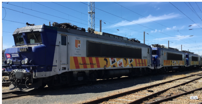
Figure 15 : Locomotive électrique BB 22200
